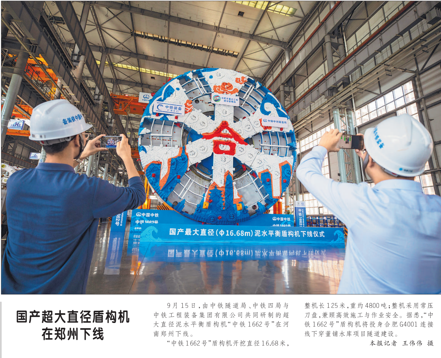
9月15日,由中铁隧道局、中铁四局与中铁工程装备集团有限公司共同研制的超大直径泥水平衡盾构机“中铁1662号”在河南郑州下线。
