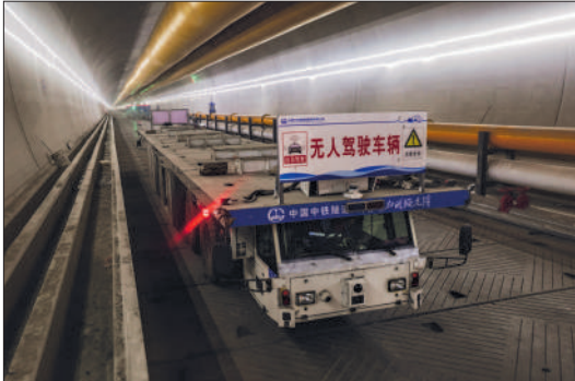
8月17日,承担运输任务的无人驾驶车辆在崇太长江隧道内缓缓前行。
