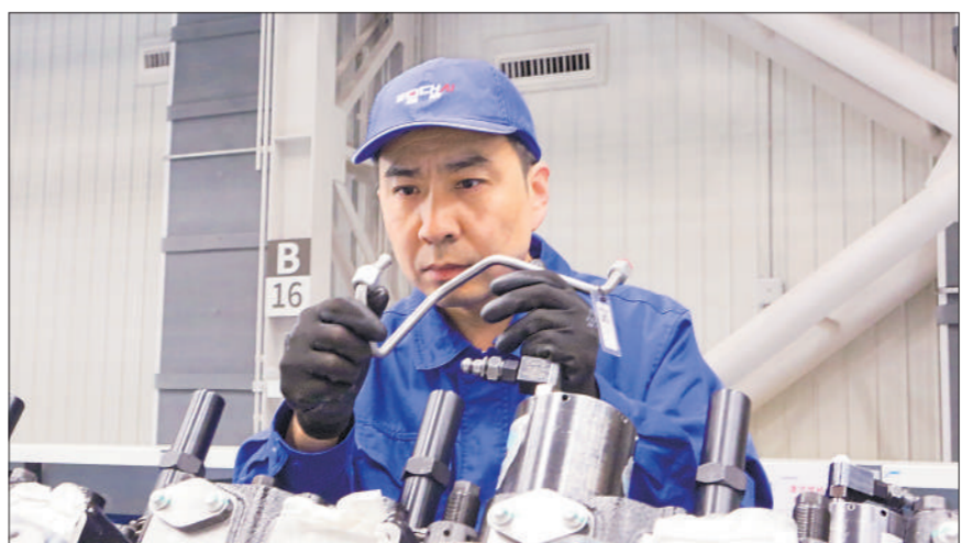
李永刚进行20M55气体机燃气管路安装前密封面检查。
