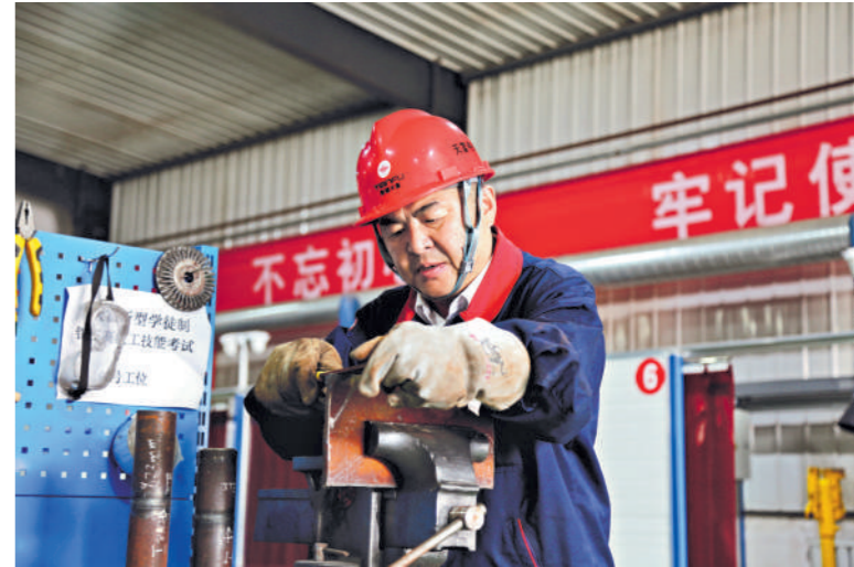
杨建立在对接焊接练习板材的坡口钝边进行打磨。 受访者供图
