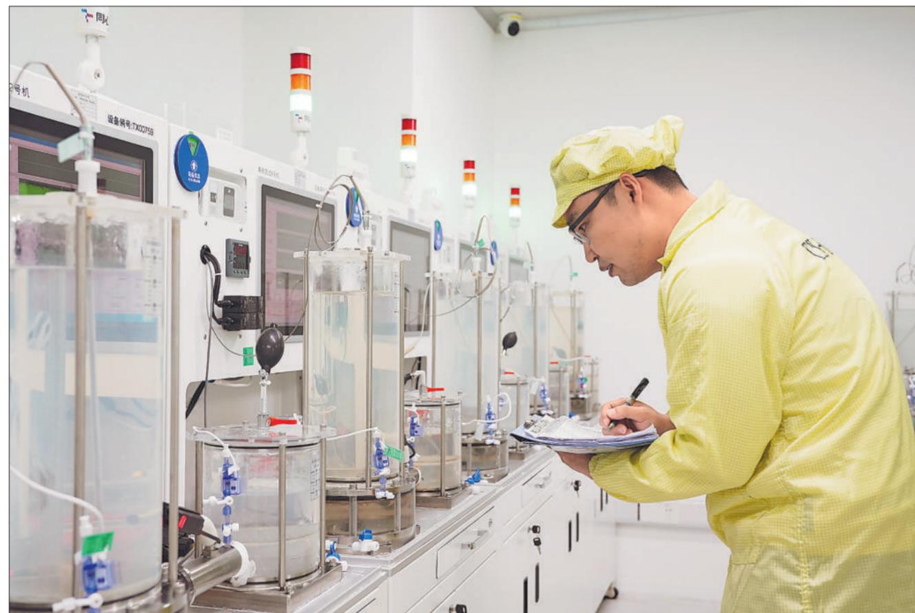
11月19日,在江苏苏州同心医疗科技股份有限公司,研发工程师在记录人工心脏泵的寿命测试数据。
