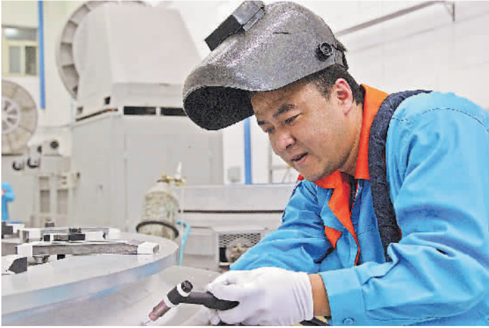
图为张铁民在进行空间站舱体连接框的点焊作业。中国航天科技集团五院529厂供图
