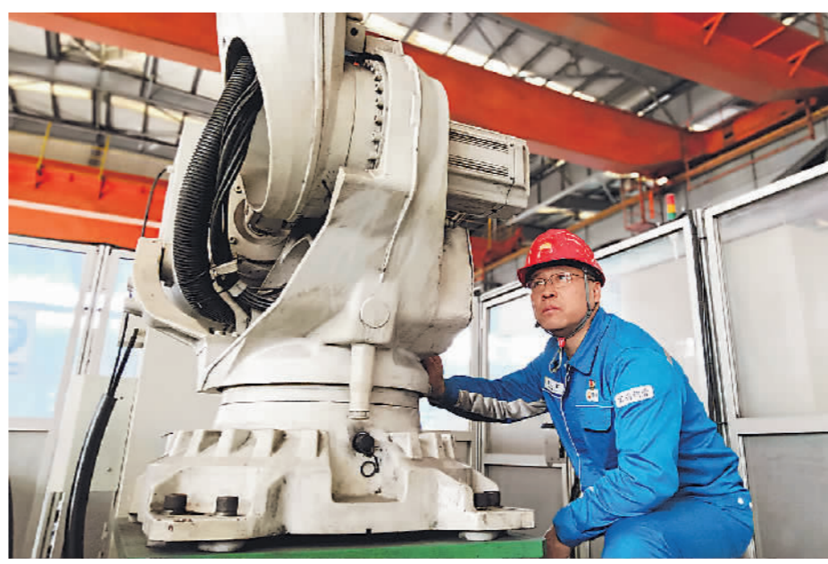
上图：一眼望不到头的智能化生产线上，只有几名操作工人，一根根钢管按照设定的程序高效运转。 左图：曹文军在观察管端焊缝自动修磨机器人运行情况。
