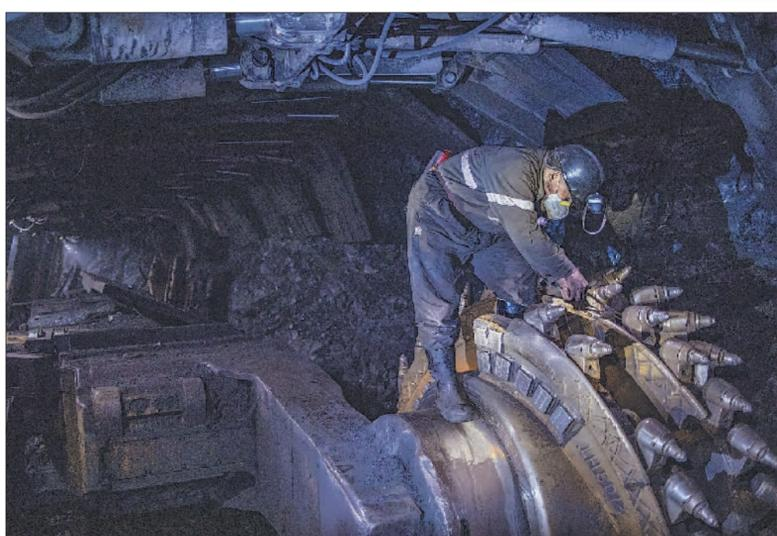
1月11日晚,在塔山煤矿的工作面上,检修工正在为一套智能化割煤机更换机组截齿。
