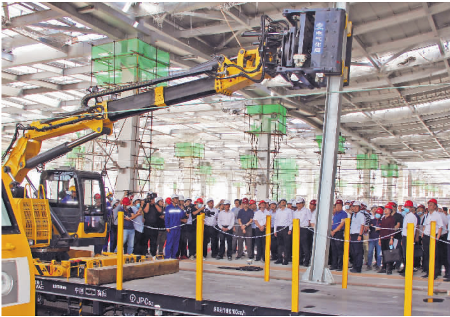
↑2020年9月3日,京雄城际铁路现场会在雄安站举行,有关专家在观摩中国铁建电气化局三公司主导研制的智能化装备立柱表演。(侯欠欠 摄)
