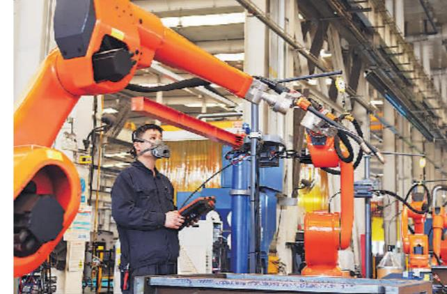
冀中装备石煤机公司毛料分厂车间,技术人员对工业智能焊接机器人进行安装调试。(杨磊涛 摄)
