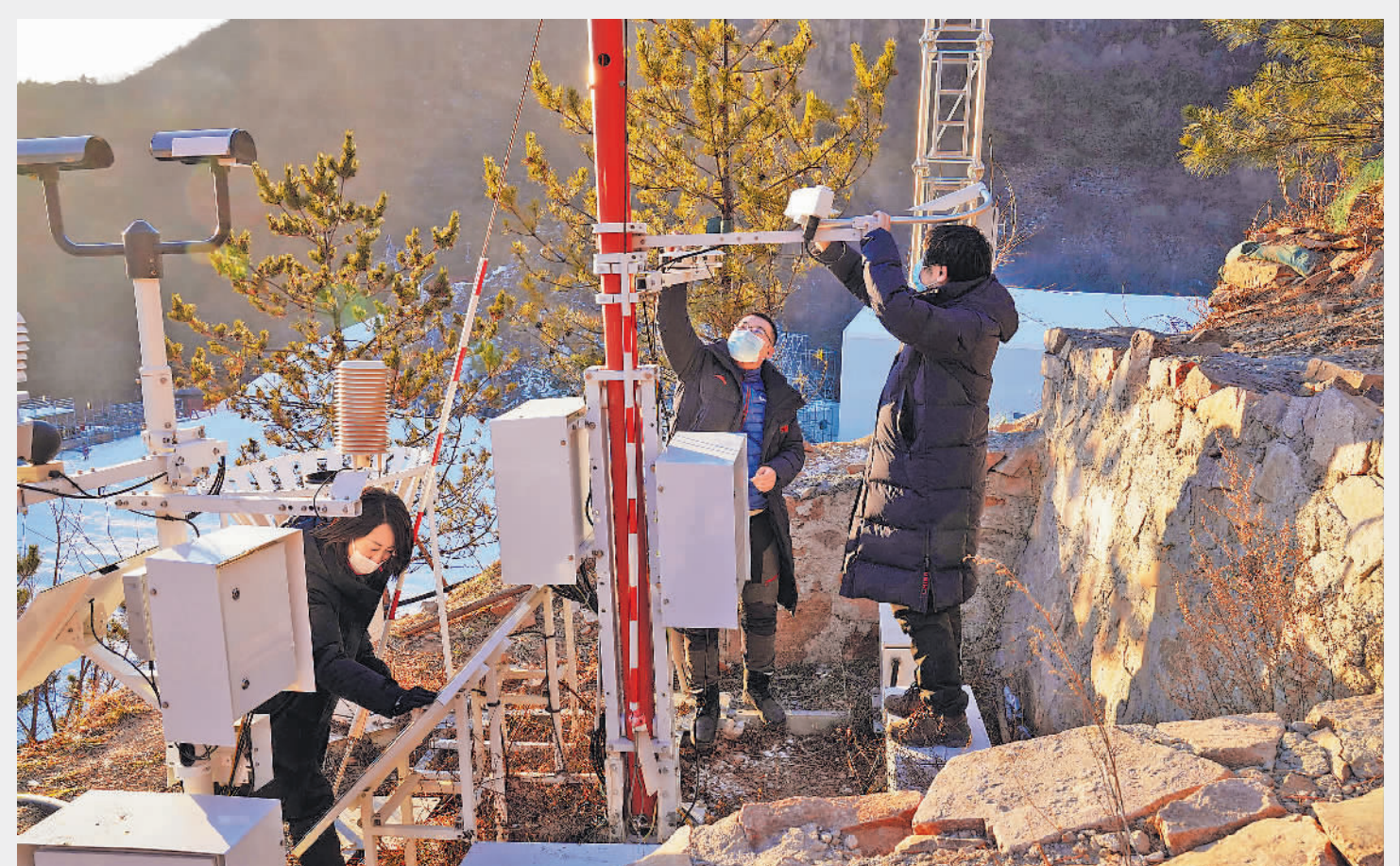
12月28日,北京延庆,国家高山滑雪中心的一处自动气象站内,冬奥延庆气象服务分中心的工作人员正在维护设备。 自2014年开始在冬奥延庆赛区建设自动气象站,截至目前,该中心已经在冬奥延庆赛区建立了完善的冬奥气象综合监测站网,构建了“三维、秒级、多要素”的冬奥监测系统,为精细化气象预报服务提供数据支撑。
