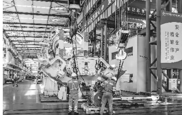
12月4日,广东省佛山市顺德区伦教镇中铁华隧联合重型装备有限公司生产车间内,多台不同类型的盾构机生产同时展开,工人开足马力忙着安装部件、焊接刀盘、调试设备,确保如期完成国内外订单。盾构机是集机械、电气、液压、传感、信息、力学等于一体的高端装备,由10万个部件组成的钢铁巨物,享有“工程机械之王”的美称,实现隧道及地下工程的智能建造。近年来,我国的盾构机先后应用到新加坡、意大利、法国等国家,为世界隧道建设提供中国装备、中国方案。
