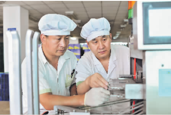
兰欢平(右)正和同事调试装盒机的折纸系统。
