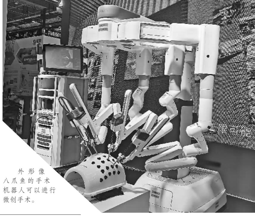
观众驻足。而在该展台的一角,还放置了一张手术工作台。工作人员告诉记者,医生只需操纵工作台上的主操作器,就可以对一旁手术台上装载的手术工具和3D高清电子内窥镜进行遥控操作,完成跨科室多适应症的微创手术治疗。
