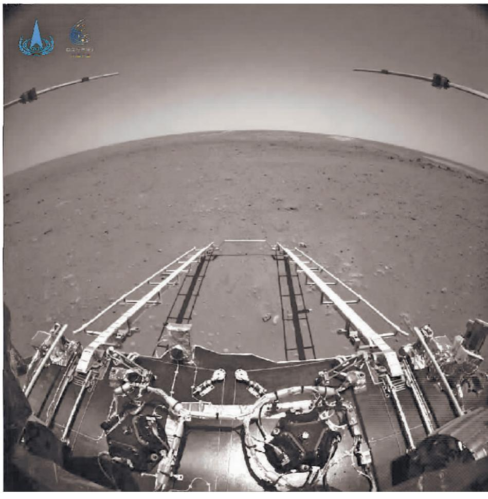
上图由火星车前避障相机拍摄,正对火星车前进方向。图中可见坡道机构展开正常;图像上部的两个伸杆为已经展开到位的次表层雷达;前进方向地形清晰。 新华社发(国家航天局供图)
