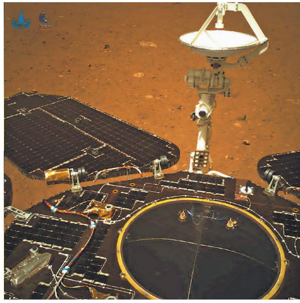
上图由导航相机拍摄,镜头指向火星车尾部。图中可见火星车太阳翼、天线展开正常到位;火星表面纹理清晰,地貌信息丰富。 新华社发(国家航天局供图)
