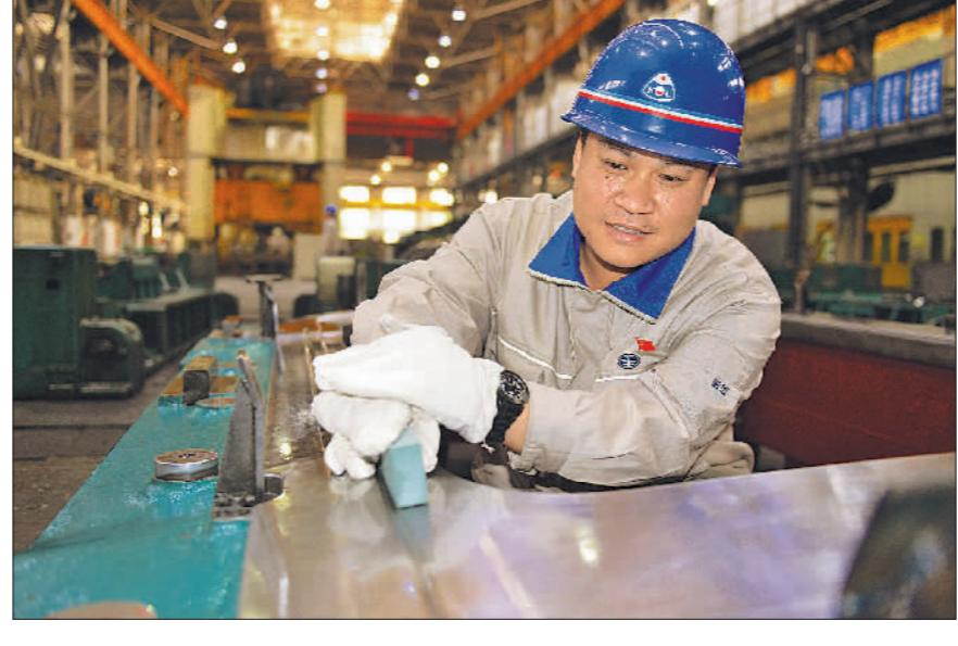
自动化冲压生产中修边工序的飞屑问题,也曾令一汽解放饱受困扰——废料刀边缘产生的细小飞屑,易黏附于制件上被带入后工序,在压力作用下,使工件上产生大量脏点、压痕。为避免不良品的产生,必须经常停线清洗模具,必须在毫厘之间精益求精。”冯斌说。
