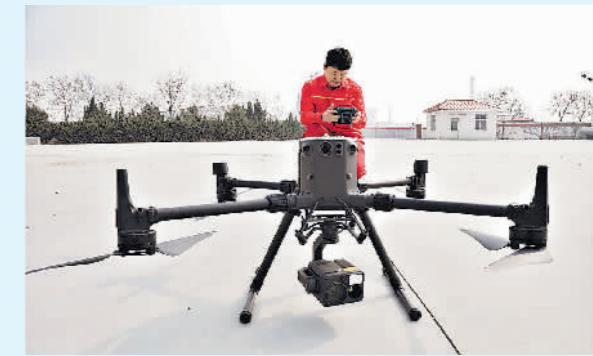
李占恒是大港油田第二采油厂作业一区一名无人机操纵手,他的工作是巡查31公里的油水井干线管道和过河道的桁架,查看是否存在泄露、是否有不法分子盗油。自从他们利用无人机巡查以来,200倍变焦、8倍远红外线成像的无人机便成为油水管线巡查的利器。
