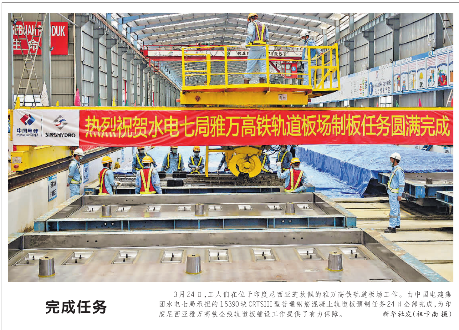
3月24日,工人们在位于印度尼西亚芝坎佩的雅万高铁轨道板场工作。由中国电建集团水电七局承担的15390块CRTSIII型普通钢筋混凝土轨道板预制任务24日全部完成,为印度尼西亚雅万高铁全线轨道板铺设工作提供了有力保障。新华社发(祖卡南 摄)
