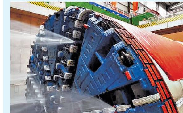
成都市区繁华地段地下管线错综复杂，为了建好地处繁华闹市的成蒲铁路紫瑞隧道，工程建设项目定制了直径12.84米的土压-泥水双模盾构机。2月26日，这一名为“紫瑞号”的“地龙”正式出发。跟随记者进入这个“庞然大物”的内部一起瞧一瞧。（本报记者 李娜 本报通讯员 邱彬斌 胡舜韬）
