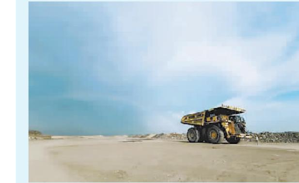
日前,载重290吨的无人驾驶矿用卡车在国家能源集团准能集团黑岱沟露天煤矿下成功试运行。下一步,研发团队将为该车的自动驾驶系统装上“眼睛”和“大脑”,以精准识别道路上的障碍物。
