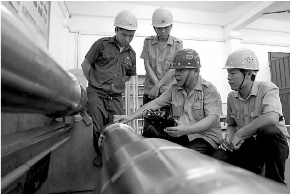
翟新生向职工传授探伤工作法,利用超声波探伤仪对机车车轴进行探伤作业。受访者供图
