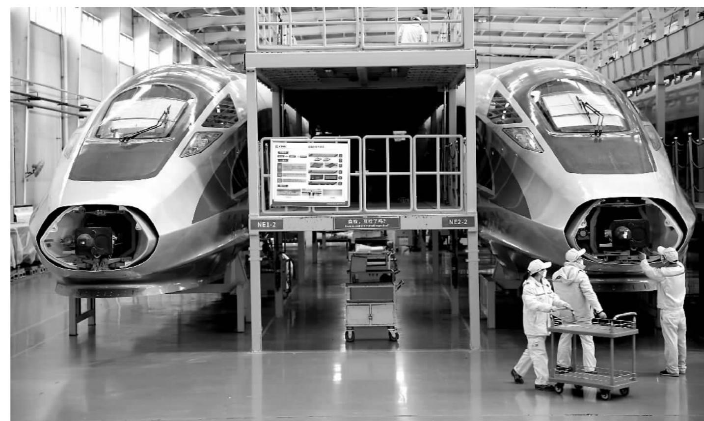
3月11日,一列编组时速350公里的“复兴号”动车组在位于青岛城阳区的中车四方股份公司正式下线。这是复工复产以来该公司完成制造的首批“复兴号”动车组。一列“复兴号”有362道工序、50多万个零部件,中车四方克服疫情期间的人员配备、配件供应、交通物流等一系列难题,确保“复兴号”如期出厂交付。
