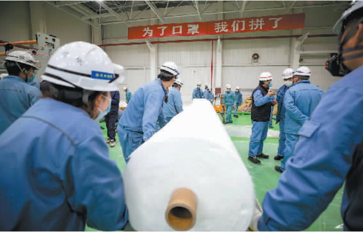
3月7日,燕山石化熔喷布生产车间内,工人们正将一卷新出产的熔喷布推往码放点集中堆放。据了解,每卷熔喷布长1600米,宽3.2米,总重128公斤,生产一卷需要47分钟。
