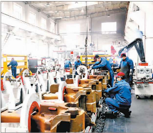
近日来,吉林车辆段紧抓疫情防控和生产恢复“两不误”。在确保安全的同时,科学提高检修效率和检修质量,为“货运增量行动”提供优质车源保障。图为该段职工正在进行车辆转向架流水线检修作业。
