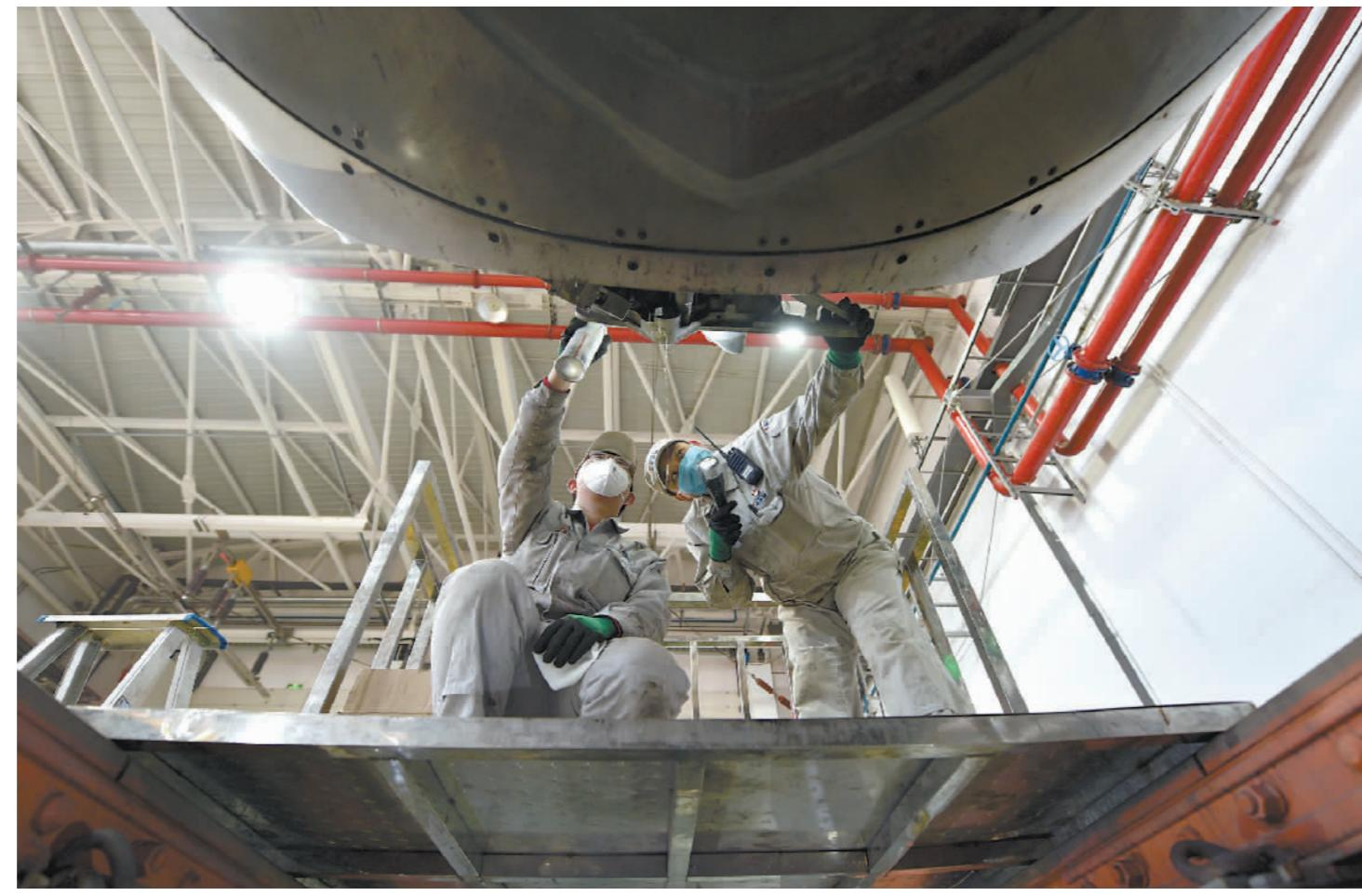
2月3日,中国铁路太原局集团公司动车组运用所地勤机械师在检查动车组头罩开闭机构及润滑情况。面对疫情,该所成立党团员突击队,发挥先锋模范作用,精检细修,按标作业,确保动车组列车安全平稳运行。 张晋彤 贾淑君 摄
