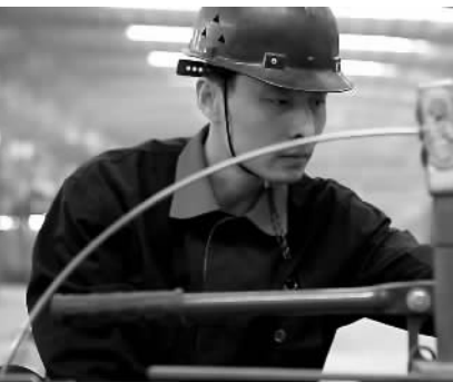
迟添奇是沈阳中辰钢结构工程有限公司的焊工,他正在操作埋弧焊,调试电流电压,焊接昆山西路桥梁顶板。
