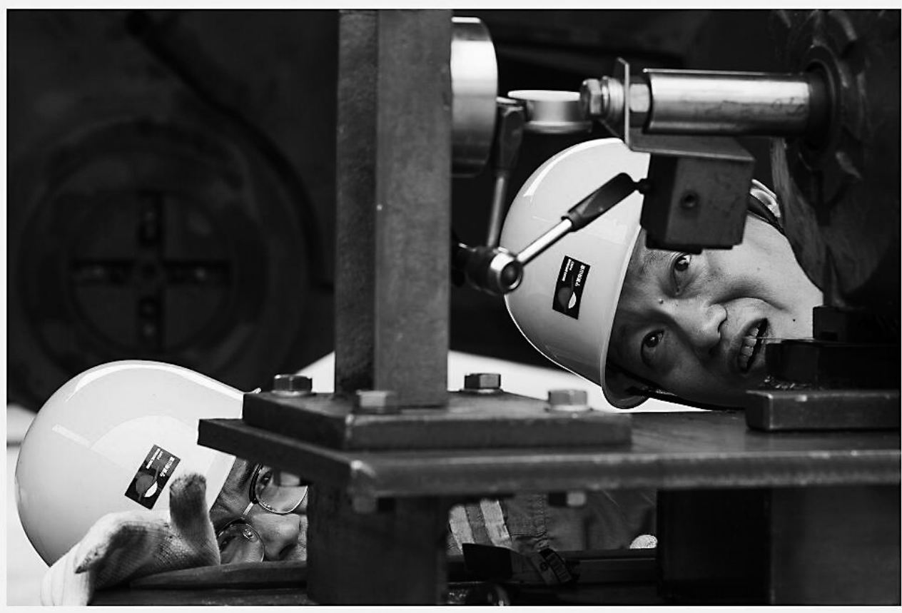
近日,宁波舟山港北仑矿石码头分公司机修分部举行“弘扬工匠精神,争做检修能手”班组技能大比拼活动。18名钳工采取两人搭配的方式展开角逐,通过调整电动机底座与模拟减速箱的同轴度,考验选手们的设备对中技术。 图为两位钳工在看百分表,其测量精度为0.01毫米,即1丝。 蒋晓东 摄
