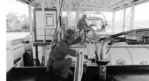
为了提升效率增加安全系数,中国石化西北油田油气运销部雅克拉末站通过优化人员、车辆、装油等一系列工艺升级,实现了24小时风雨装车不间断,装一辆车较以前减少20分钟时间,装油效率大幅提升。图为该站工人站在经过改造升级的装车栈桥遮挡棚下进行紧张的原油罐车装车作业。
