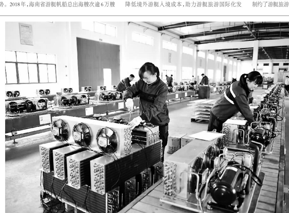
5月20日,位于湖北省宜昌市夷陵经济开发区东城工业园的银岭冷冻设备有限公司生产车间一片繁忙,工人们加紧制造“集装箱式”移动冷库,以满足市场订单的需求。该公司自主研发的制冷机组嵌入式一体化“集装箱式”移动冷库,不仅解决了建造冷库带来的用地问题,还极大地降低了客户的成本投入。
