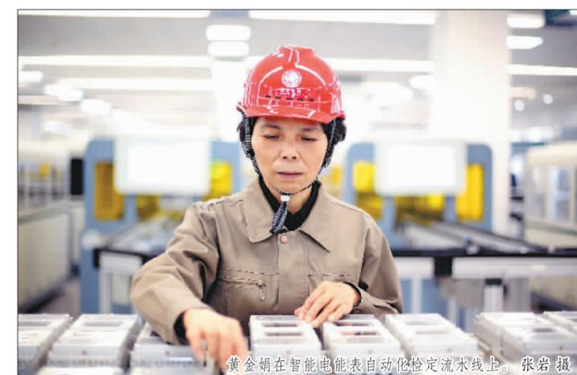
黄金娟在智能电能表自动化检定流水线上。张培 摄
