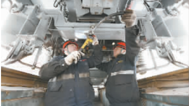
为确保机车健康上线,大板车务段检修职工每天要对几十台机车转向架进行检修,他们也被称为火车头“足疗师”。(张伟摄)
