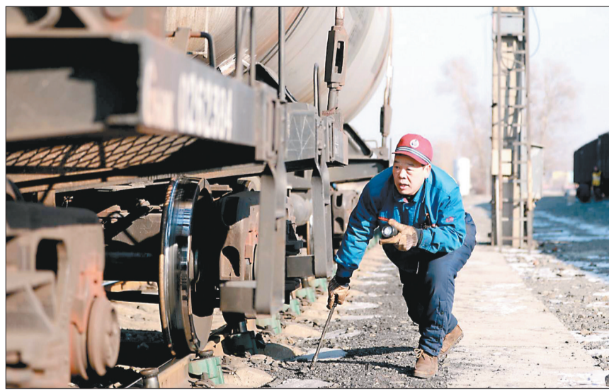
春运期间,吉林车辆段检修运用车间检车员加强车辆走行部、制动部检查力度,消除车
