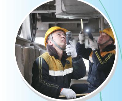
延安机务段对入库机车精检细修，消除常见故障隐患，为繁忙春运提供优质机车。图为近日，该段检修车间职工在检查机车走行部状态。（郭军山 摄）
