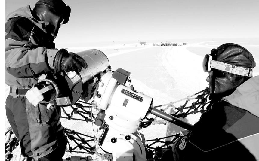
视宁度测量望远镜在南极昆仑站完成安装
