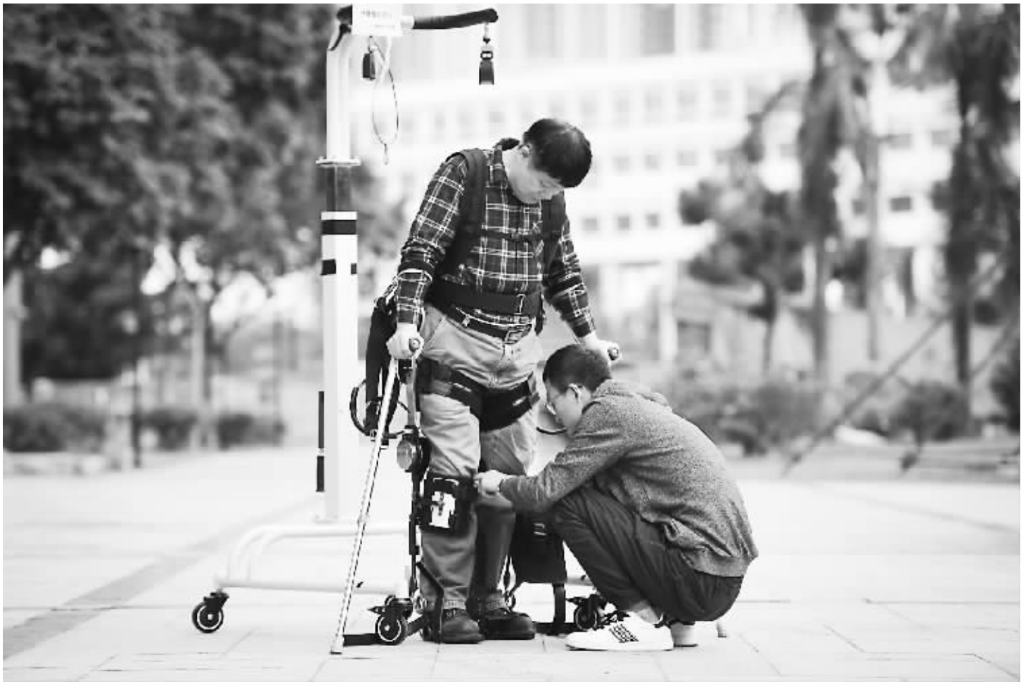
12月11日，在中科院深圳先进技术研究院，智能仿生研究中心研究助理马勋举（右）在室外测试时帮助高级工程师彭安思穿戴下肢助力外骨骼机器人。
