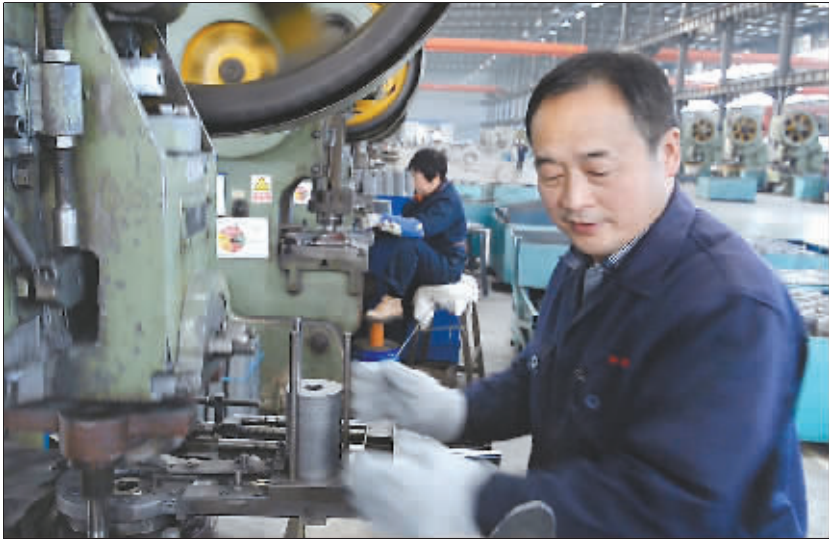
▲第二代冲床安装机械臂后,操作工的手开始远离危险区域。
