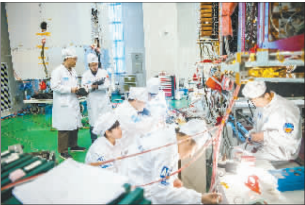
2017年4月22日,技术人员正插接一颗卫星的低频电缆。卫星装配是一项繁琐细致的工程,每一步骤都要做到精准、零误差。
