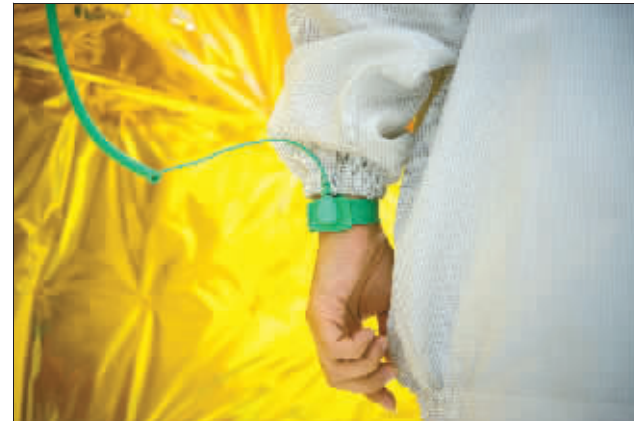
为防止静电对卫星产生影响,一些与星体有直接接触的技术人员会带上防静电手环。
