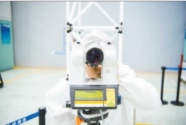
技术人员通过精密仪器对一颗即将进入下一测试阶段的卫星进行星体表面精测。
