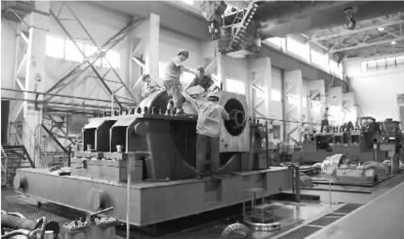
图为杭汽轮总装车间里,四五个工人正在装配一台汽轮机。本报记者 邹偶然 摄
