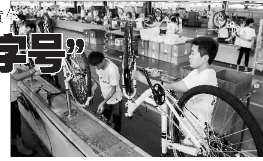
图为小黄车生产流水线，工人们正在为单车安装刹车绳。
