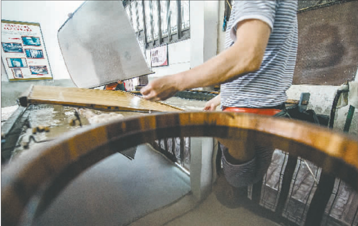
5月21日,全国劳模周东红和他的搭档正在进行捞纸作业,这也是古法宣纸生产中最难的一道工序。捞纸用的山泉水性寒凉,师傅们每捞一次就要把手放到旁边的水桶里保温一下,以保持手感。
