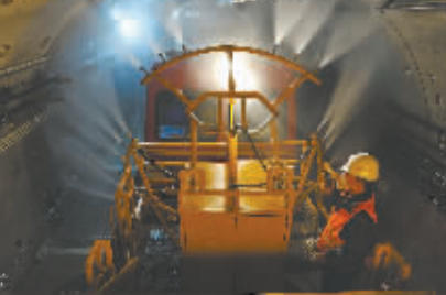
重视科技创新,自主研发的地铁隧道水冲洗车在项目施工中屡建勋功 (潘平/摄)
