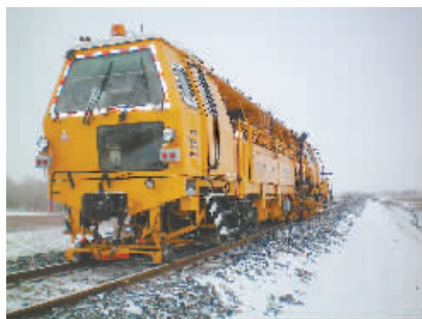
捣固车正在奎北线作业
