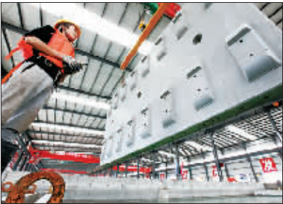
近日,经过反复核查与检测,有着先张法“西南第一板”美誉的中铁上海工程局成贵铁路一公司乐山制板场通过了国家工业产品生产许可证审查,由此成为国内首家取得国家工业产品生产许可证的制板场。图为作业人员将刚脱模的轨道板放入水池养护。(祥连胜 摄)
