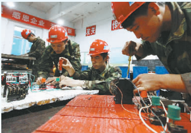
山西焦煤汾西矿业集团高阳煤矿机电区王斌俊创新工作室中,研究人员进行井下猴车自动开停装置改造
