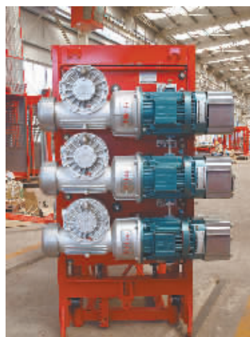
施工升降机新型驱动机构的组配项目
