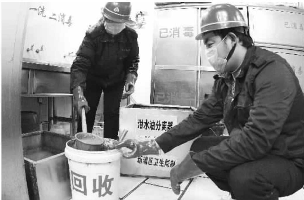
江苏连云港市新浦区推广泔水油分离器 江苏连云港市新浦区推广泔水油分离器,餐厨垃圾中的废弃油脂全部回收,统一运至油脂化工企业进行处理,最终变为生物柴油,有效杜绝了地沟油流入居民餐桌。 耿玉和/CFP
