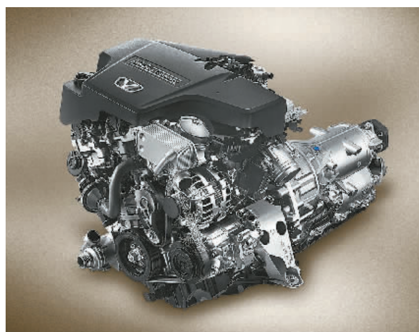
搭载在华颂7上的宝马授权生产的2.0T发动机
