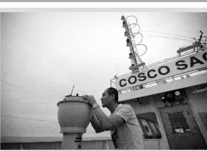
大副谢功礼在驾驶室外依据方位仪测定驾驶方向。李雪峰摄
