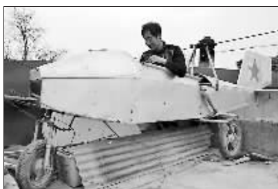
3月22日,甘肃平凉市崆峒区四十里铺镇七府村,在陈连学家的屋顶上,停放着一架通体银白、长4.20米、宽5.10米、高约1.60米的飞机。机身由铝合金打造,机舱能容纳一个成年人乘坐,切割、焊、铆有板有眼,精致程度超乎想象。 “只要掌握了空气动力学,飞机上天不难”,从未接受过飞行培训的陈连学说:“我造飞机的想法已有四五年,因为儿子结婚,女儿也有工作,家里欠债还清了,就开始动手造飞机。”
