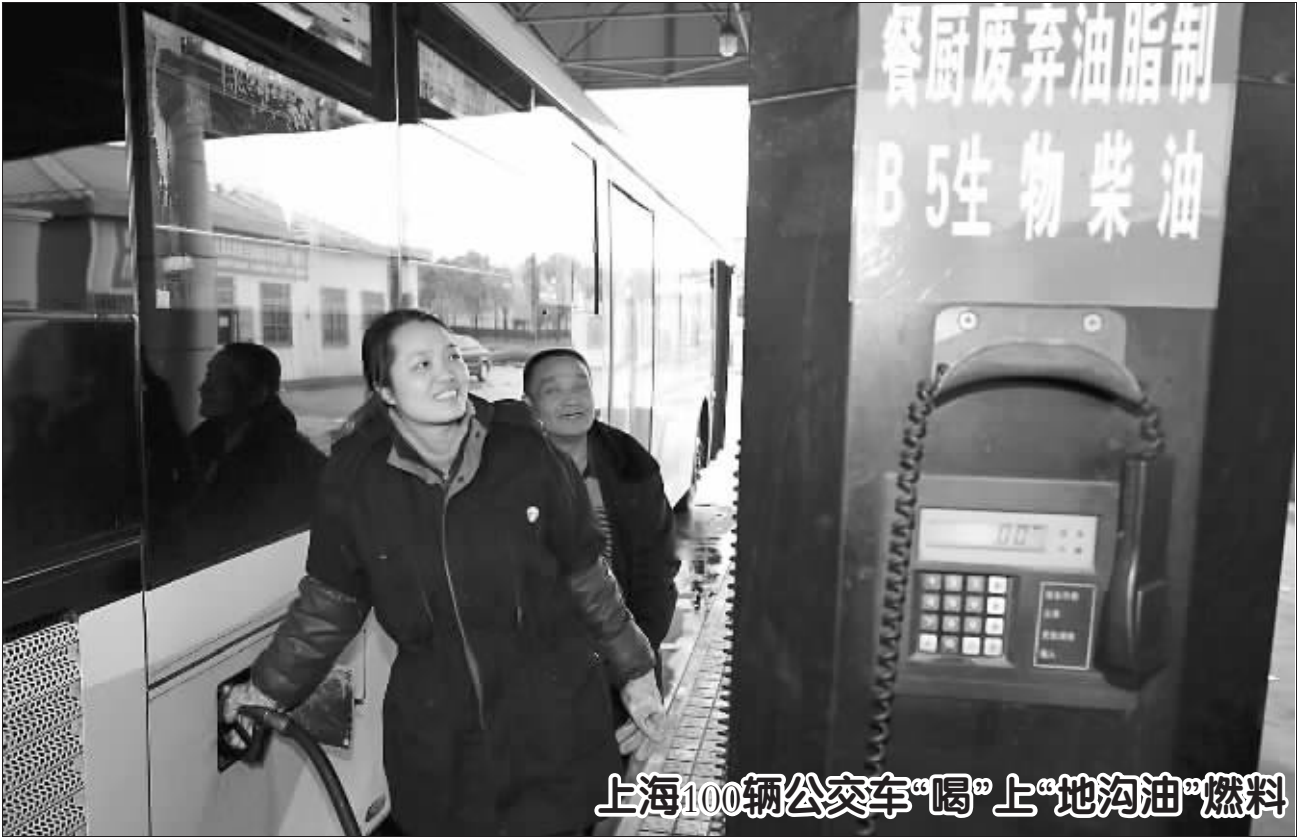
1月14日，巴士一汽的工作人员在给公交车辆加餐厨废弃油脂制生物柴油。 近日，上海巴士一汽公司利用餐厨废弃油脂提炼生物柴油作为公交车混合燃料的示范项目通过专家评定。据介绍，该公司已有10条线路100辆公交车“喝”上“地沟油”燃料。从2013年9月起，巴士一汽公司就协同上海市食安办、同济大学相关部门，以餐饮垃圾油(地沟油)为原料，通过脂交换工艺制成代替石化柴油的再生性柴油燃料。经测试，使用“地沟油”燃料的公交车运营车辆动力基本不减，颗粒物排放降低近一成。
