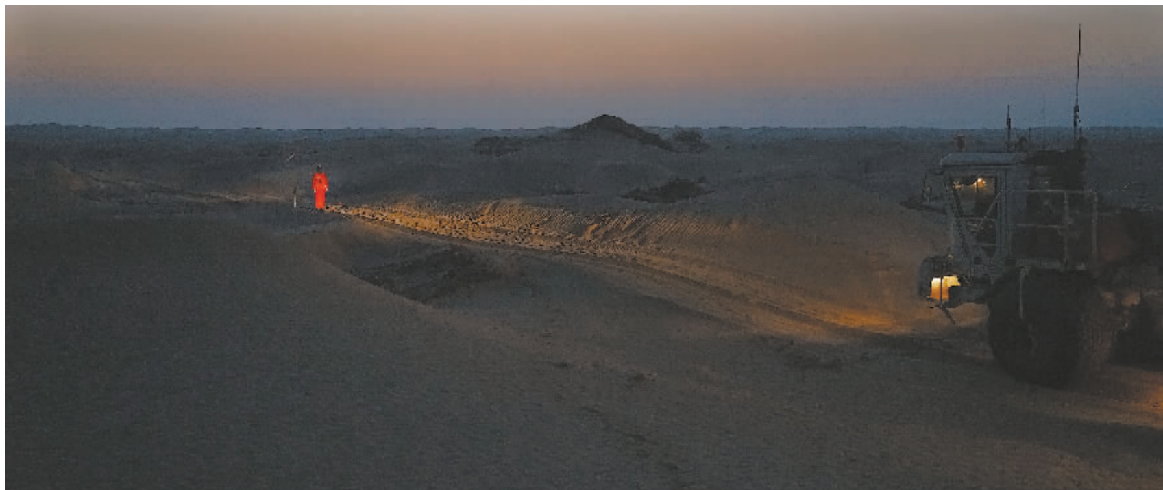
正在实施塔里木盆地进行“皮山三维地震勘探资料采集项目”的中石化地球物理华东分公司645队，在塔里木盆地沙漠区采用可控震源采集技术的地震采集技术。这是中石化在流动性高大沙漠区大规模使用可控震源地震采集首次获得成功，并在技术上取得关键突破。
